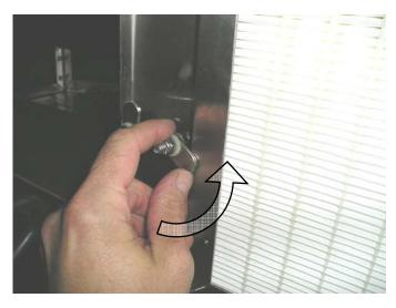
STEP #4 - TURN LOCKING TABS 90 deg WHILE GENTLY PUSHING ON FILTER FROM FILTER EDGE ONLY
